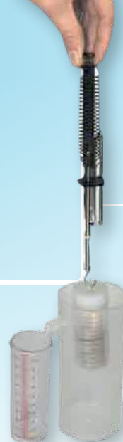
Principio de Arquímedes. Set demostrativo QH 0031
